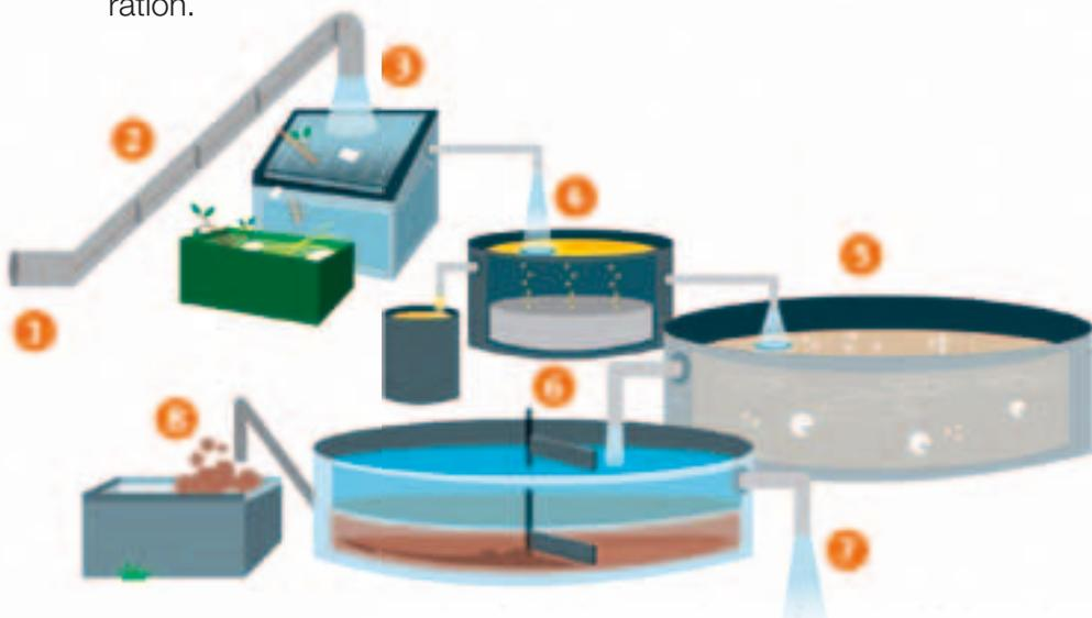
Dans la station d'épuration, les différentes sortes de polluants contenus dans les eaux usées subissent un traitement spécifique. L'épuration des eaux usées nécessite donc une succession d'étapes faisant appel à des traitements physiques, physico-chimiques et biologiques.
